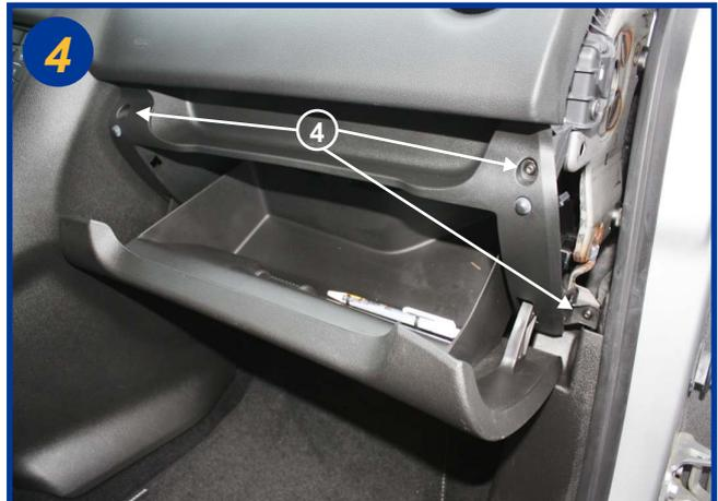
Ouvrir la boîte à gants et à l'aide d'un tournevis torx (T20) dévisser dans un premier temps les 3 vis (4).
