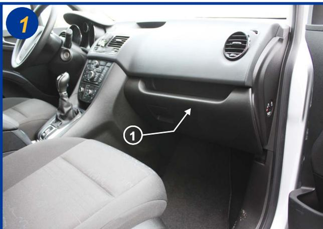
Le filtre d'habitacle est situé à l'intérieur du véhicule, coté passager derrière la boîte à gants (1). Il est nécessaire de sortir le bloc boîte à gants complet.
