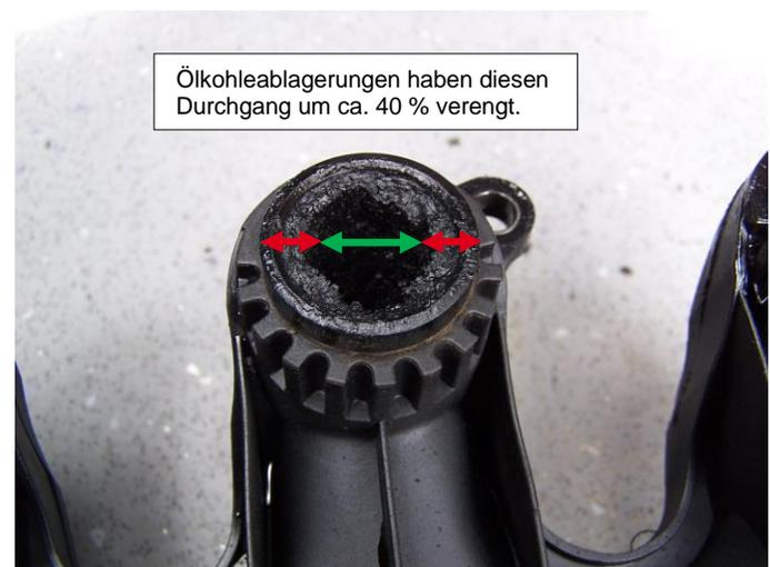
Ansaugkrümmer nach dem Mündungsbereich der Kurbelgehäuse-Entlüftung befunden, ggf. säubern. Ladeluftkühler demontieren, eingelagertes Öl entleeren, nachfolgend intensive Spülung durchführen.
