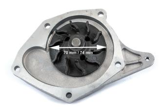
Schaufelrad-Durchmesser der ausgebauten Kühlmittelpumpe ermitteln
