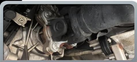
Der Grund dafür ist möglicherweise ein defektes oder verschlissenes Kreuzgelenk. Dies kann zum kompletten Ausfall des Antriebsstranges führen. Sie sollten das Gelenk im Zweifelsfall immer ersetzen.
