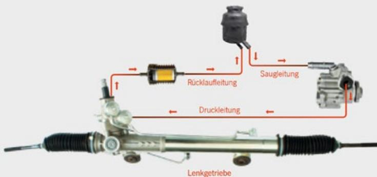
Im Lenkungs-Schutzfilter von MAPCO® hält ein Hochleistungsmagnet fast 100 Prozent aller magnetischen Partikel fest, im Membranfilterpapier werden die nichtmagnetischen Schwebeteilchen aufgefangen. Das Gehäuse ist absolut dicht und widersteht Steinschlägen sowie Streusalzen.
