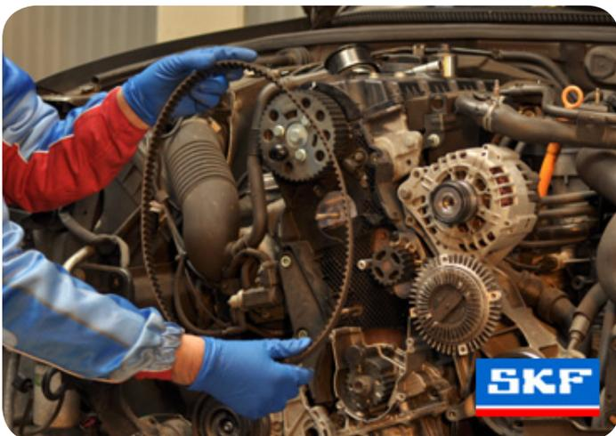
5. Riemenspannermutter lockern und Riemenspanner mit einem geeigneten Werkzeug gegen den Uhrzeigersinn drehen.
