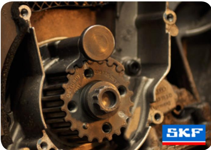
4. Nockenwellen- und Kurbelwellenräder mit passenden Werkzeugen blockieren.
